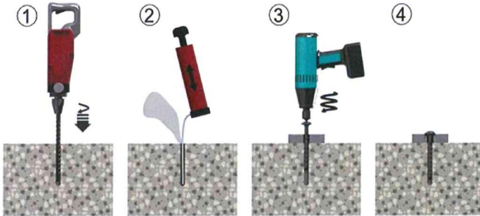
**Montageanleitung in vorgespannten Hohlraumdeckenplatten**
